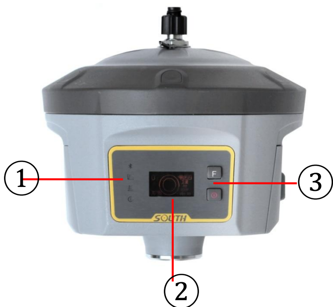
Рисунок 1.1 – Общий вид приемника 1 – Световые индикаторы
