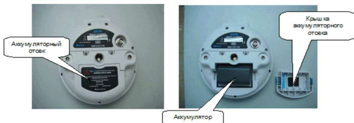
Рисунок 2.4 – Установка аккумулятора в S82T
